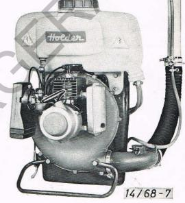
Sprühen: Schalöl Kalk Farbe Holzschutzmittel
