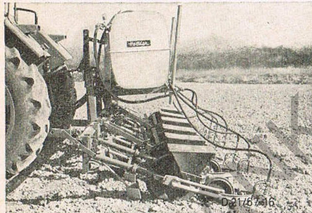
③ ASB als Bandspritze ASB line sprayer ASB pr. traitements en ligne ASB como pulverizador de siembra (en fajas)
